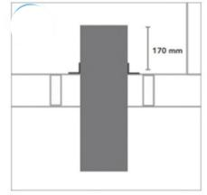
Le tuyaux doit dépasser le plancher d'environ 170 mm. Dans le sous-sol, la longueur est en fonction du hauteur du local est le bac de collecte. Fixer le tuyau sur le plancher avec des vis et des équerres de fixation.
