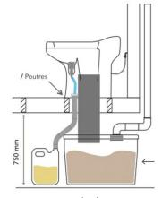
Hauteur minimale de 750 mm Mesurer la dimension du poutre afin de calculer la longueur du tuyau de chute (a)
