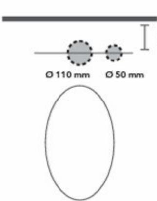
>115 mm CW : «distance minimale entre le centre du tuyau d'évacuation jusqu'au mur »
