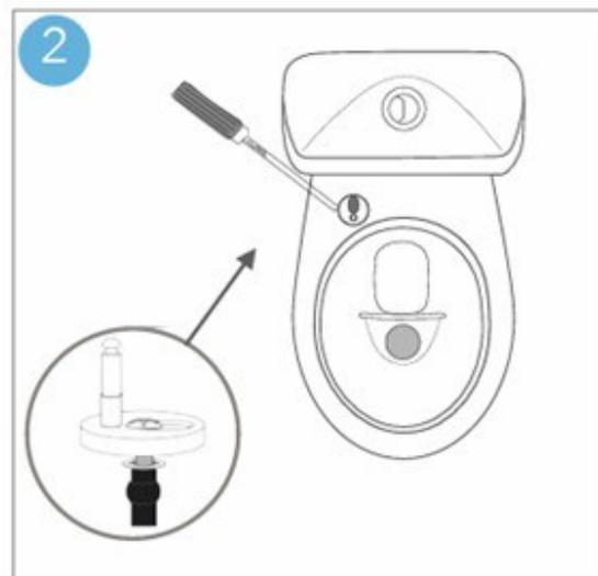
Poussez la fixation dans le trou du siège et assurez-vous qu'elle est centrée et alignée avec le siège.
