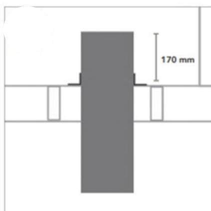
La conduite descendante doit dépasser d'environ 170 mm au-dessus du sol. Dans le sous-sol, en fonction du bac de collecte. Fixer la conduite descendante dans le sol avec des vis et des équerres de fixation.
