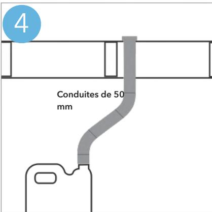
4 Installez une évacuation pour les urines avec un tuyau de 50 mm vers un réservoir d'urines qui correspond à vos besoins. Pressez le manchon du tuyau vers le sol et étanchez avec du silicone.
