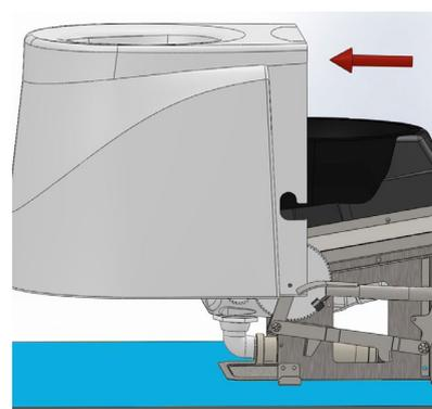
Devisser un peu l'attache au sol du tapis. positionner la patte anti vol sous la vis avec le centre du trou aligné sur le trait, revisser
