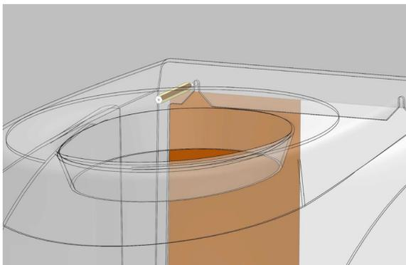
Enlever le siège et mettre les tirefonds (6x40) sur les marques faites au crayon.
