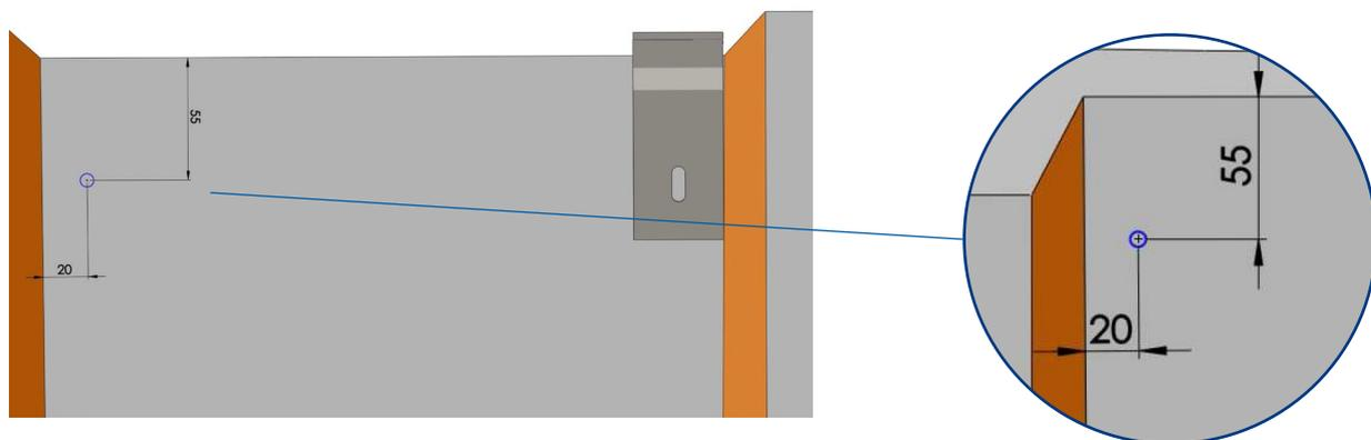
Viser les pattes en utilisant la lumière pour régler la position.
