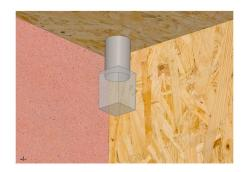
Il est conseillé de protéger le ventilateur avec un grillage anti-mouches positionné entre le local et le ventilateur. Il faut prévoir un grillage suffisamment grand pour ne pas ralentir le débit d'air.
