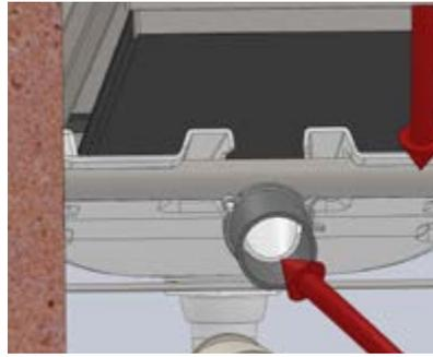
Le bac doit se poser sur l'axe de la pédale et sa goulotte doit entrer dans le tuyau de trop plein
