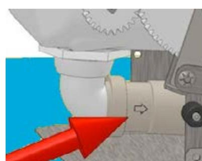
En faisant attention à la flèche qui indique le sens d'écoulement
