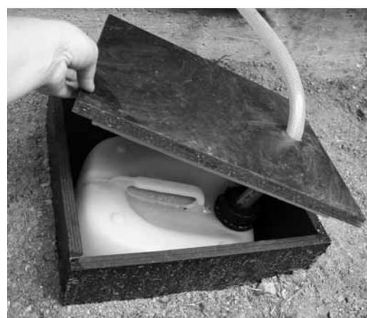
Fig. 3. Réservoir de collecte du lixiviat
