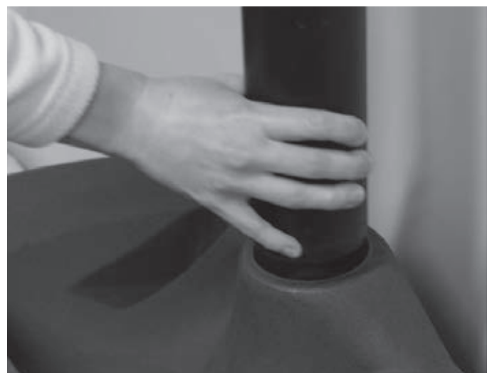
3. Démontage du tuyau de ventilation.
