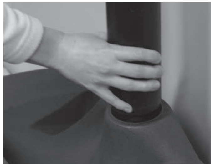
3. Abmontieren des Entlüftungsrohres
